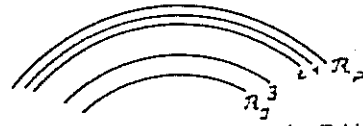
Abb. 15: Zur Abgrenzung der Felder für die Teilung des kleinen Breitenringes. R_A und R_2 sind die Randkreise der betr. ebenen Fläche, 1, 2 und 3 die Kreise, die die Felder für die Teilungen abgrenzen. Der Abstand 2-3 ist, wie im Text angegeben, = dem dreifachen Abstand 1-2.
